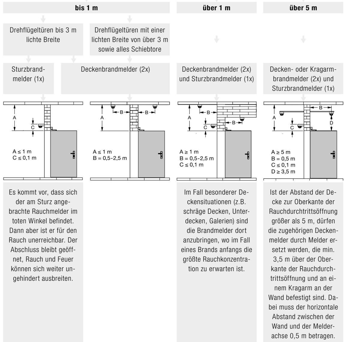
Hinweis: Ein Brand-/Thermomelder erfasst gemäß DIBt einen Bereich von bis zu 2 m auf jede Seite (Öffnungsbreite bis 4 m). Größere Öffnungsbreiten verlangen deshalb entsprechend mehr Geräte.
